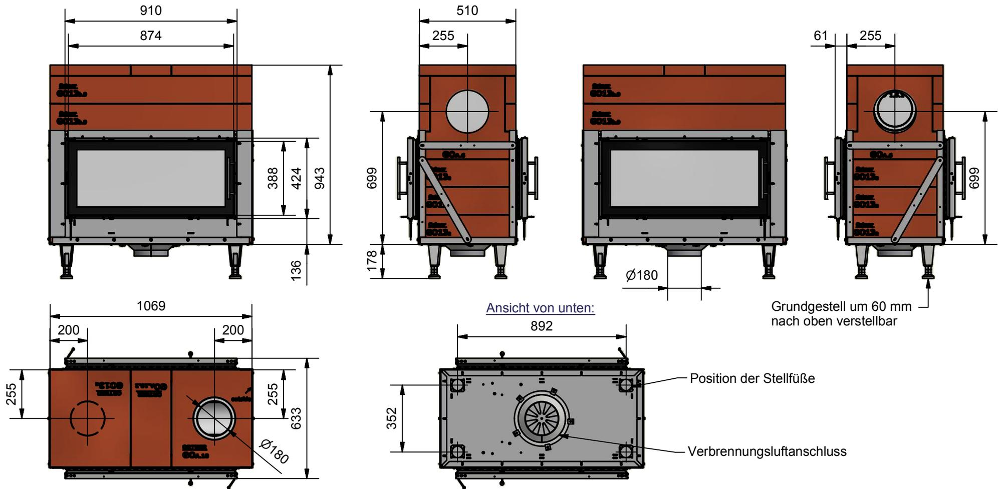
Alle Höhenangaben gelten bei einer Mörtelfugenstärke von 3 mm, einer Fasermattenstärke von 3 mm (im zusammengesetzten Zustand) und vollständig nach unten geschraubtem Grundgestell.
